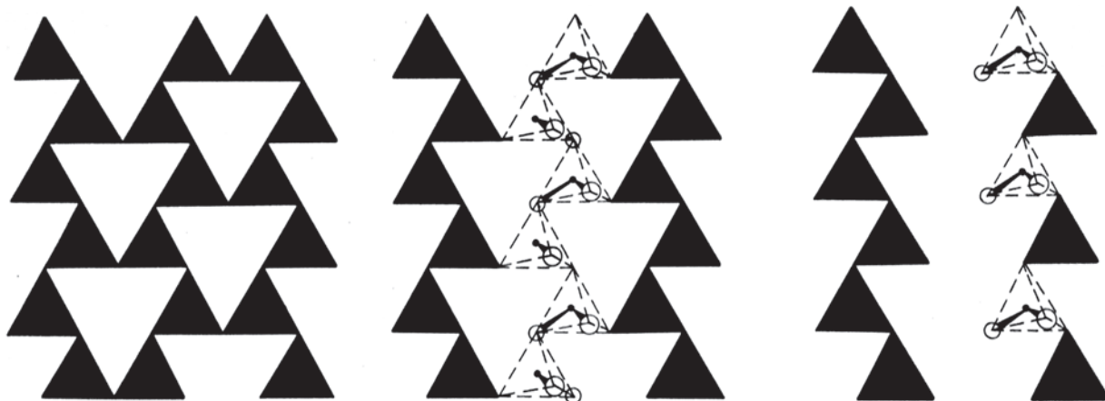
Рис. 5. Схема утворення слюдяної сітки шляхом силіфікації піроксенового ланцюжка (Lazarenko et al., 1973)
